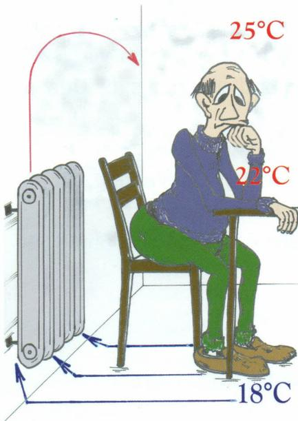
Die Luft bleibt sauber, wird weder umgewälzt, noch wird ihr, wie bei Verbrennungsvorgängen üblich, Sauerstoff entzogen. Kein Wärmeverlust durch zusätzliches Belüften. Ausserdem verbrennen Staubpartikel nicht zu schädlichem Russ. Ein Befeuchten der Luft ist nicht notwendig. Unsere Empfehlung für alle Menschen, die eine Stauballergie haben oder besonders empfindlich auf Schadstoffe in der Luft reagieren ist, sich mit Wärmewellen-Heizungen ein angenehmes, gesundes Raumklima zu schaffen.
